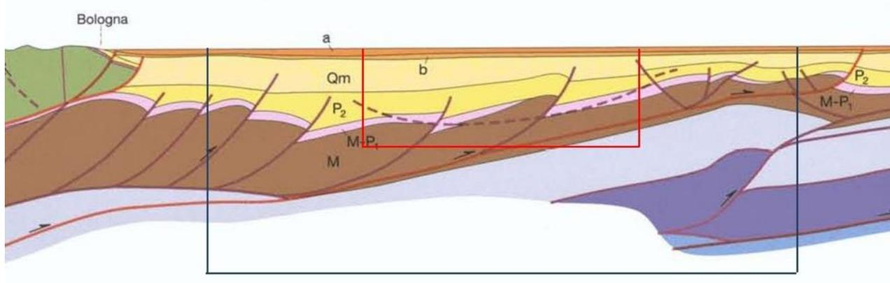
**Figura 3.** Proiezioni dei domini di rilevazione sulla sezione C-C' di Boccaletti *et al.* (2004). Linea rossa: dominio interno; linea blu: dominio esteso. Le profondità dei domini DI e DE sono di 5 e 11 km, rispettivamente
